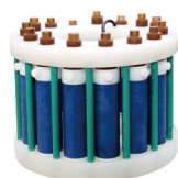
十五位高压组合消解罐架
